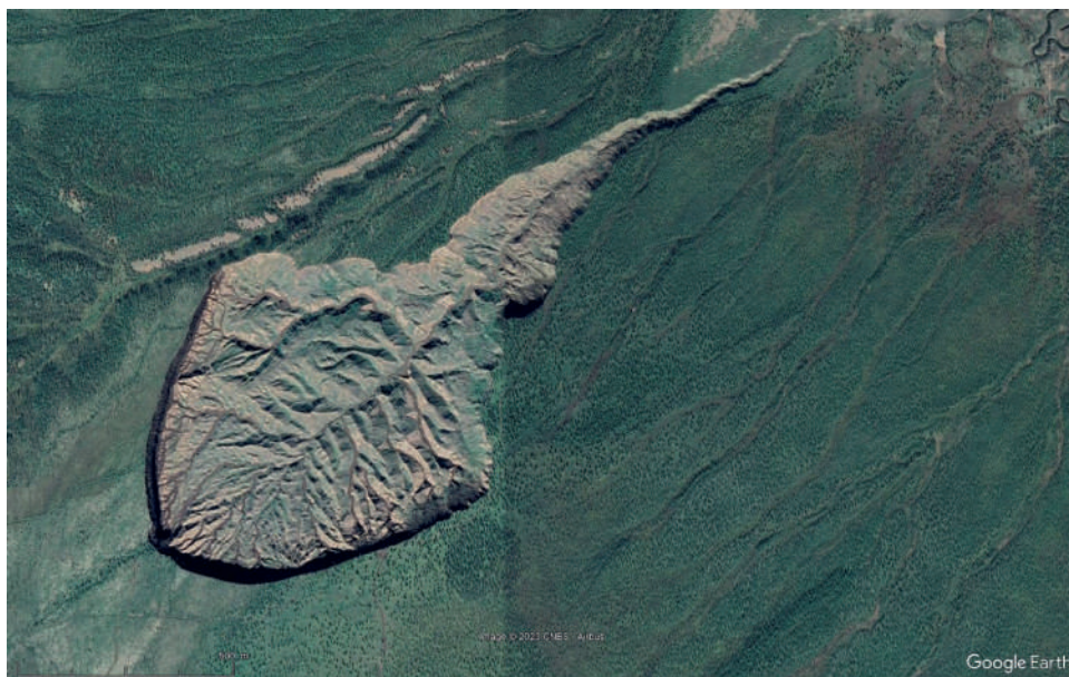
Fig. 9 - Cratère d'effondrement de Batagaika en Sibérie, Russie, surnommé « porte de l'enfer » : une dépression de type thermokarst d'1 km de long et environ 100 m de profondeur formée par le dégel de la glace en profondeur.
